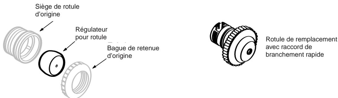
Pour adapter une conduite de retour de 1-1/4 pouces (3,2 cm) ou de 2 pouces (5 cm), utilisez le UWF Kit d'adaptateur Polaris livré avec votre nettoyeur.
